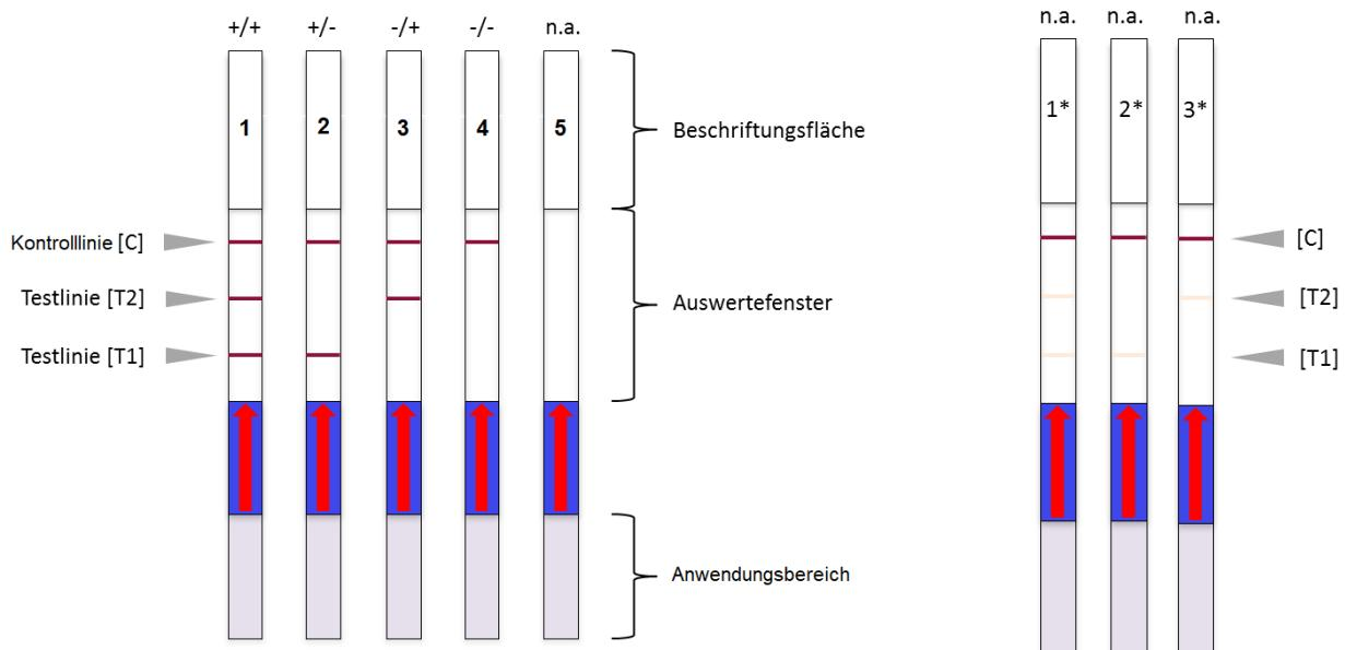
Die Funktionskontrolle [C-Linie] bestätigt die Funktionalität des Teststreifens. Die Amplifikationskontrolle [T2-Linie] gibt Aufschluss über die Funktionalität der PCR. Die Testlinie [T1-Linie] zeigt an, ob eine *Alicyclobacillus*-Kontamination vorliegt.
